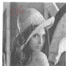
(a) 压缩比 128:1 的恢复图象 (PSNR=26.5dB)
